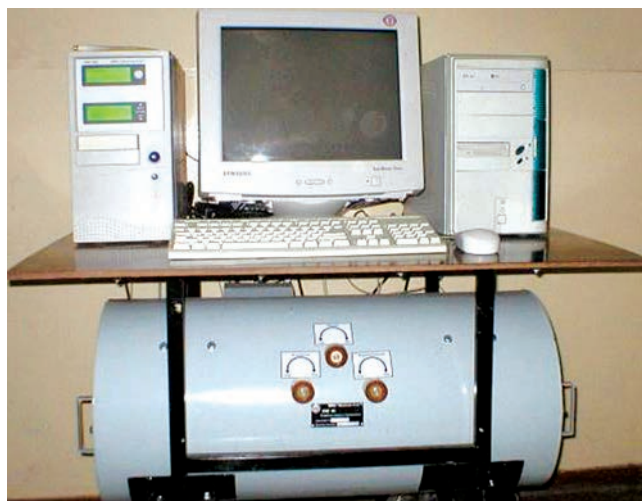
Рис. 1. Устройство контроля герметичности УКГФ.
