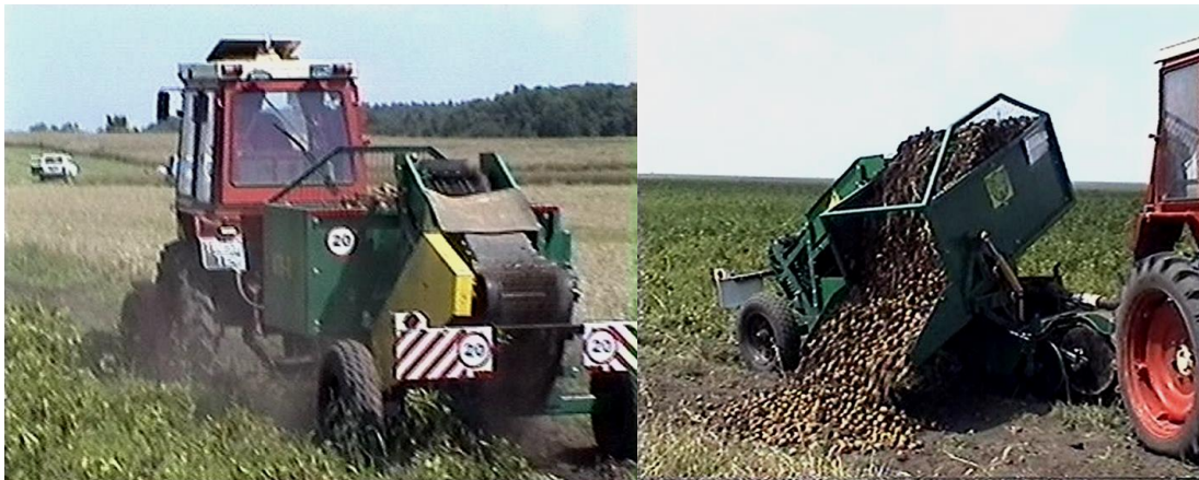
Рис. 5. Загальний вигляд картоплезнабирального комбайна КПК-1 та його робота в польових умовах
