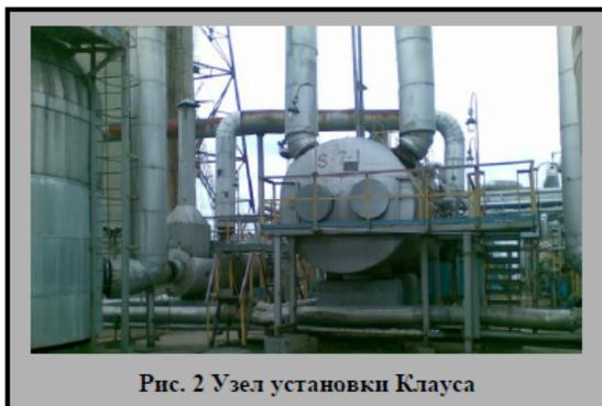
Рис. 2 Узел установки Клауса
