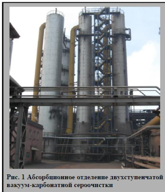
Рис. 1 Абсорбционное отделение двухступенчатой вакуум-карбонатной сероочистки
