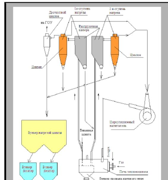
Рис. 1 Принципиальная схема системы нагрева установки термической подготовки угольной шихты (УТПШ)
