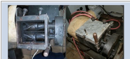
Рис. 2 Світлина лабораторного пристрою для розподілу коксохімічних відходів на поверхні твердих частинок-носіїв
