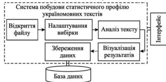
Рис. 2. Графічне зображення структурної схеми програмної системи / Graphic representation of the structural diagram of the software system
