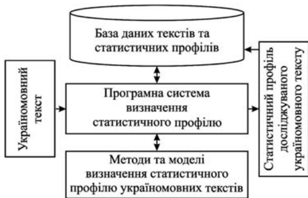
Рис. 1. Структура інформаційної технології визначення статистичного профілю україномовних текстів / The structure of information technology for determining the statistical profile of Ukrainian-language texts
