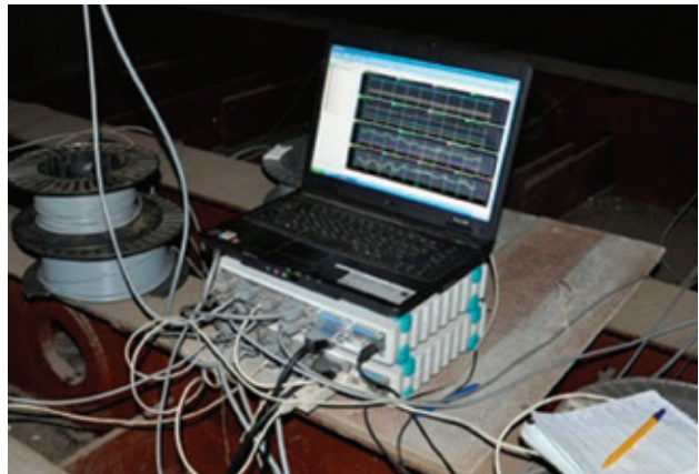
Вимірювальний комплекс із підсилювачем «Spider 8» для реєстрації прогинів та напружень в елементах прогонових будов мостів
