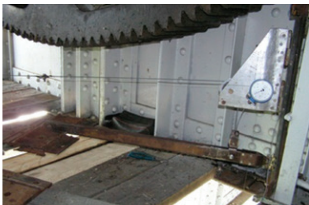
Прилад, розроблений співробітниками лабораторії для вимірювання рівномірності натягу канатів вертикально-підйомної прогонової будови
