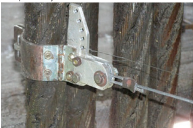
Прилад, розроблений співробітниками лабораторії для вимірювання рівномірності натягу канатів вертикально-підйомної прогонової будови
