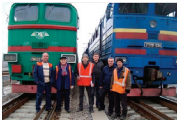
Випробувальне навантаження — локомотиви 2ТЭ116 та 2М629 із вагою на вісь 23 та 21 т
