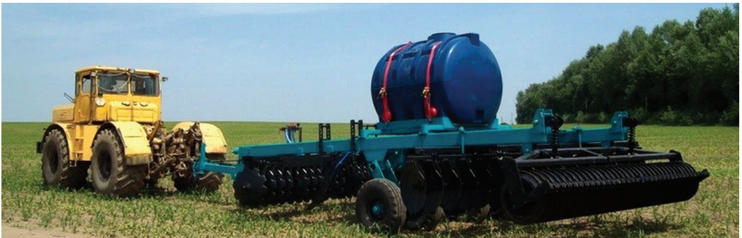
Рис. 3. Диско-чизельна борона БДВП-4,2-01 з обладнанням для внесення рідких добрив і біодеструкторів
