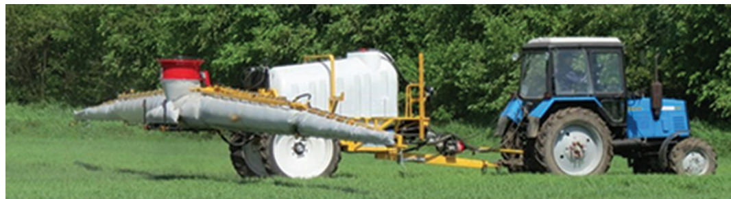
Рис. 9. Обприскувач ШТОРМ-3000-18, обладнаний пневматичною системою осадження крапель
