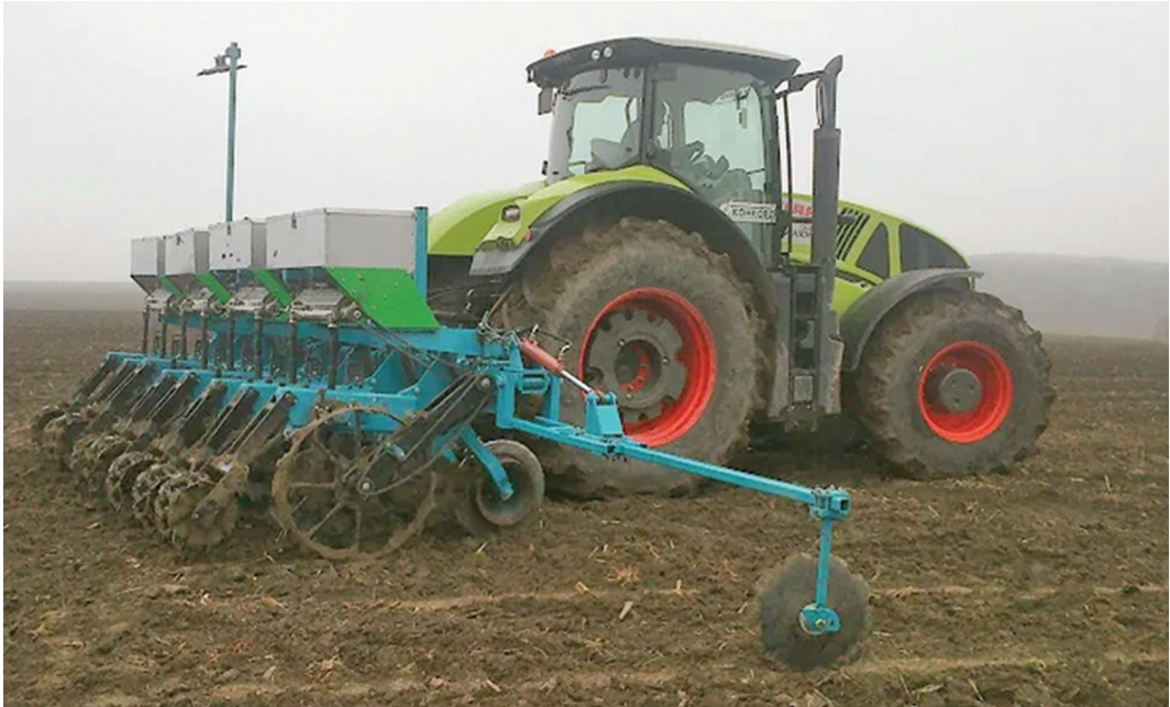
Рис. 4. Агрегат смугового обробітку ґрунту АСОГ-8 з обладнанням для внесення мінеральних добрив
