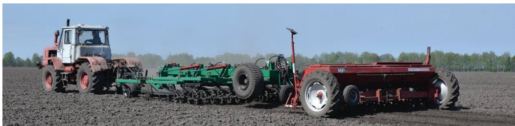
Рис. 5. Ґрунтообробно-посівний агрегат (АКГ-4,5 + сівалка)
