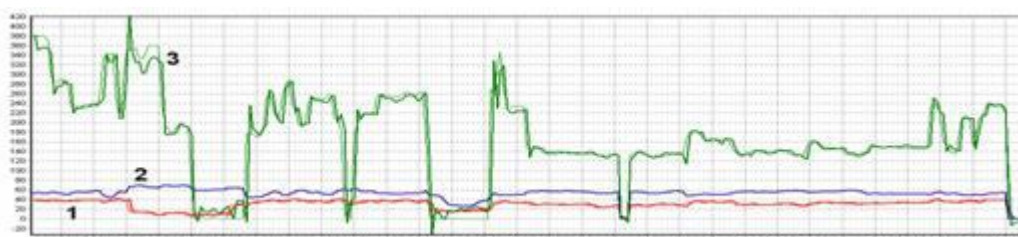
Рис. 2. Зверху графіки фактичних (тонка лінія) та змодельовані VARX-частиною моделі В-І дані часових рядів трьох виходів системи (1 – температура газу (С°) на виході з ділянки трубопроводу, 2 – тиск газу
