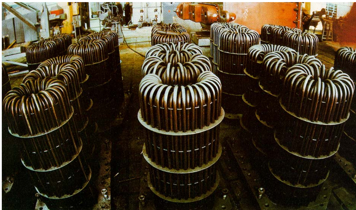
Рис. 11. Трубные пучки эжекторов
