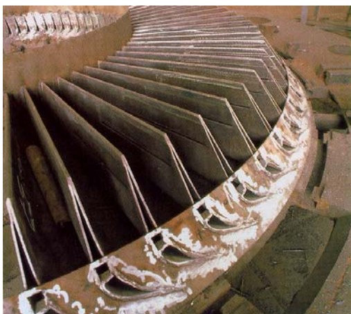
Рис. 8. Вварка направляющих лопаток диафрагмы паровой турбины в бандажную ленту
