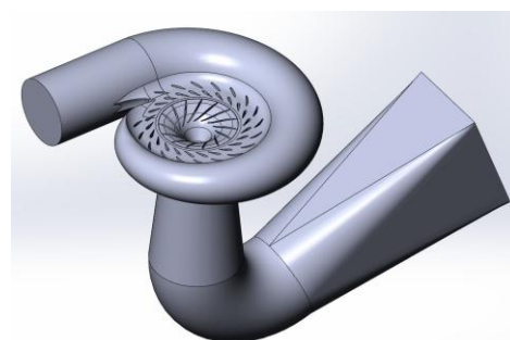
Рис. 3. Твердотельная модель радиально-осевой гидротурбины
