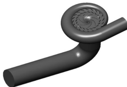
Рис. 2. Твердотельная модель проточной части насос-турбины
