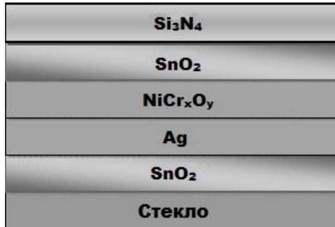
Рис. 4. Структура мягкого покрытия Е-стекла (Double Low-E):
