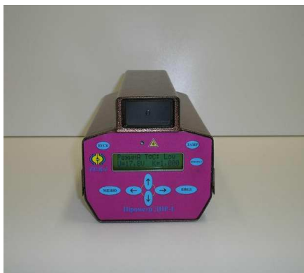
Рис. 4 – Цифровий індикатор пірометра спектрального відношення ДПР-1
