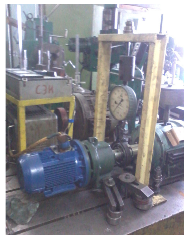
Рисунок – Фото мотор-редуктора 6МП-40-71-111 в испытательном стенде
