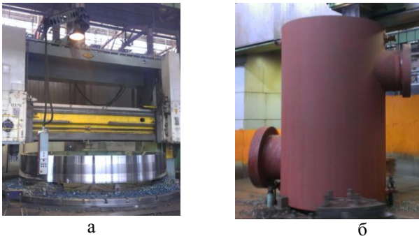
Рис. 1 – Крупногабаритные корпусные детали обрабатываемые на тяжелых карусельных станках в условиях ПАО «ЭМСС» и ПАО «НКМЗ»: а – наружная обработка, крупногабаритной корпусной детали; б – растачивание корпусной детали
