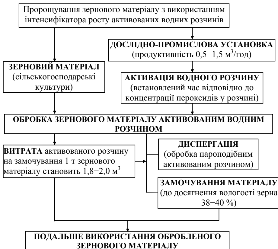
Рис. 3. Принципова схема практичної реалізації отриманих результатів дослідження
