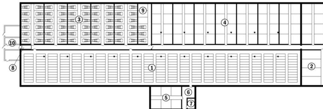
Рис. 2. Внутрішнє планування свинарника-репродуктора: 1 – секція холостих та порослих свиноматок; 2 – секція ремонтних свинок; 3 – блок опоросу; 4 – блок дорощування відлучених порослят; 5 – секція утримання кнурів; 6 – відділення для взяття сперми; 7 – лабораторія пункту штучного осіменіння; 8 – зона підготовки свиноматки до опоросу; 9 – резервна секція; 10 – блок допоміжних приміщень (добудова)
