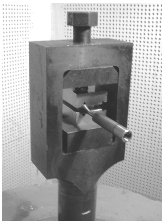
Рис. 2. Схема нагружения образца при испытаниях на усталость
