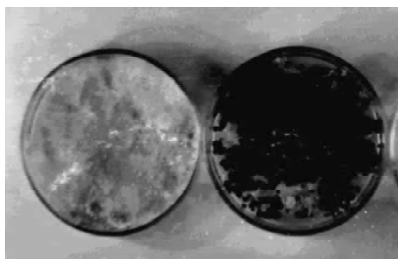
Рисунок 5 – Чашки Петри с выделенной культурой грибов с поверхности нефлюатированного бетона (левая) и отсутствием грибного заражения на флюатированном образце (правая).
