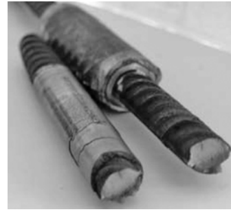
Рис. 17. Характер руйнування при втомному випробуванні
