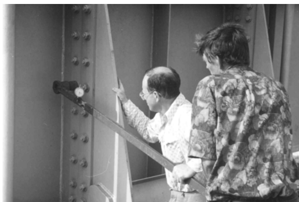
Рис. 11. Измерение усилий в высокопрочных болтах
