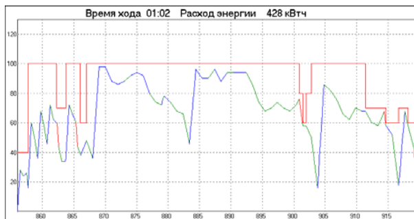
Рис. 3. Оптимизация режимов тяги по общему расходу электроэнергии
