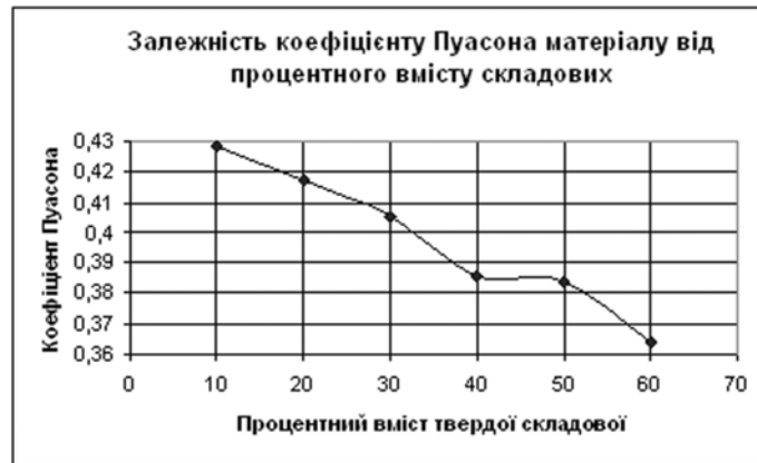
Рис. 12. Залежність коефіцієнту Пуасона матеріалу від відсоткового вмісту твердої (SnSb) і м'якої (Pb) складових
