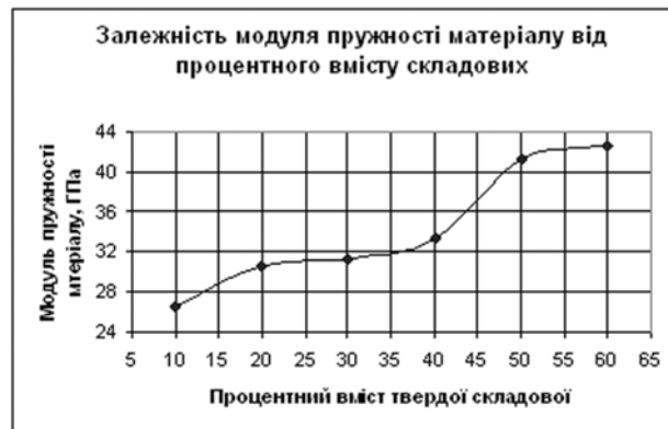
Рис. 11. Залежність модуля пружності матеріалу від відсоткового вмісту твердої (SnSb) і м'якої (Pb) складових
