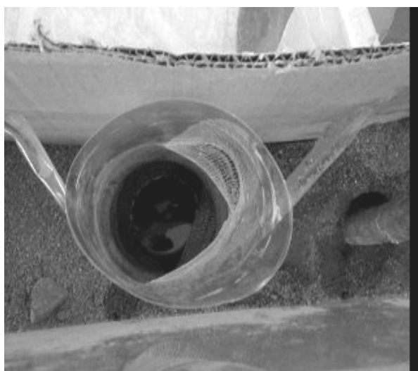
Рис. 4. Жидкость, собранная в коллекторе, после начала нейтрализации, t = 80 с
