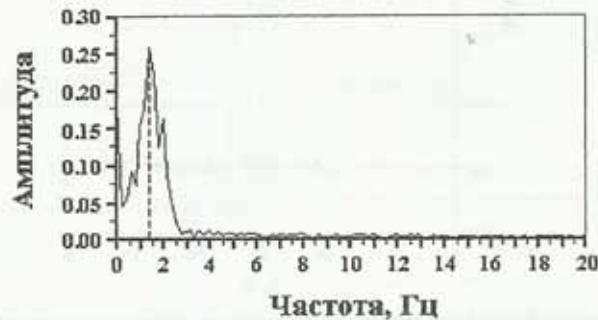
Рис. 8. Спектр амплітуд дисперсійного хвосту волни, утвореного при відбитті хвосту хвилі від берегового схилу 60^\circ
