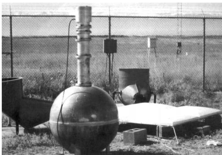
Рис. 7. Низкочастотный акустический излучатель типа резонатора Гельмгольца (США, Колорадо [12])
