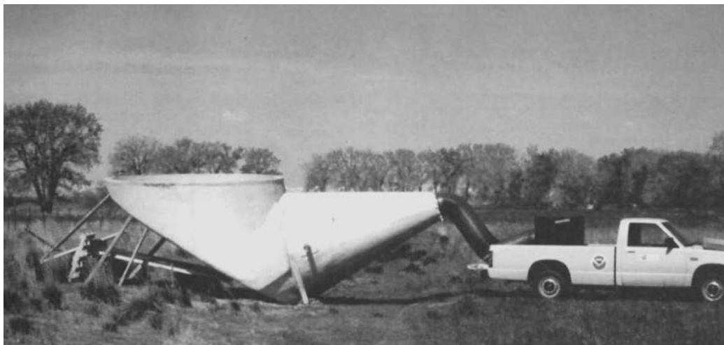
Рис. 6. Генератор низкочастотных акустических колебаний (США, Колорадо [12])
