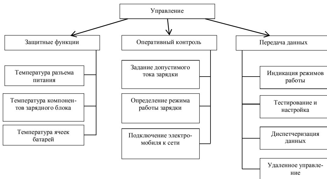
Рис. 3 – Иерархическая структура автоматизированной зарядной станции для электромобилей
