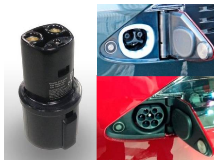
Рис. 1 – Переходник разъема зарядной станции для электромобилей Tesla Model S
