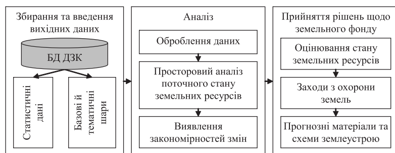
Мал. 1. Узагальнена схема геоінформаційного моделювання та оцінювання стану земельних ресурсів
