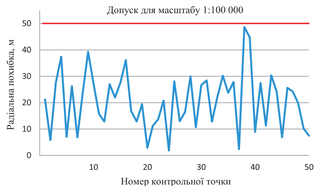
Мал. 5. Радіальні похибки на контрольних точках. Червона лінія вказує гранично допустиму похибку для масштабу 1:100 000
