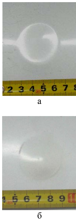
Рис. 4. Фрагмент обшивки кузова автомобиля «Citroen»: а – образование вмятины; б – удаление ранее образованной вмятины
