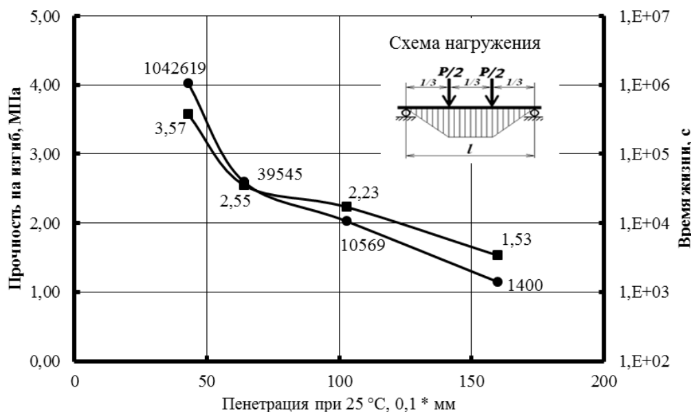
Рис. 1. Зависимости долговечности (-●-) при заданном напряжении ( \sigma_{ст} = 50 МПа) и прочности (-■-) на изгиб от пенетрации битума при 22 °С
