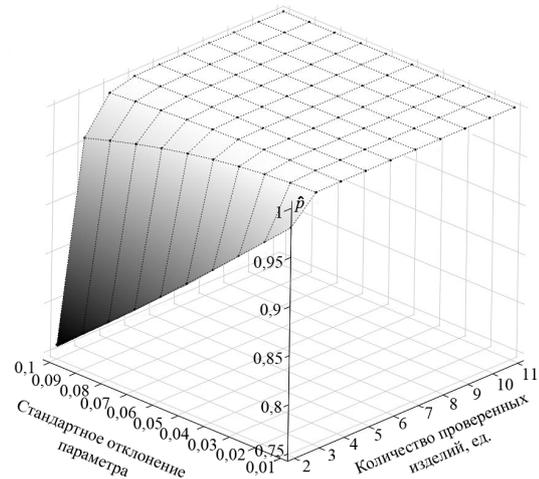
Рис. 1. Зависимость вероятности  $\hat{p}$  от количества проверяемых изделий  $n$  и стандартного отклонения параметра  $\sigma$  (при  $m=0,5$ )
