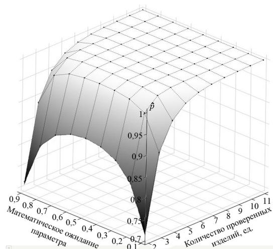
Рис. 2. Зависимость вероятности  $\hat{p}$  от количества проверяемых изделий  $n$  и математического ожидания параметра  $m$  (при  $\sigma = 0,05$ )
