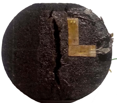
Рис. 3. Фотография образца с трещиной после испытания
