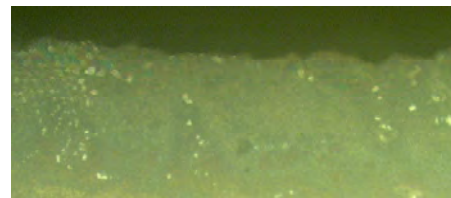
Рис. 1. Микроструктура внутренней поверхности (охлаждаемых) каналов рабочих лопаток до проведения операции ГИП (вариант 0), × 250
