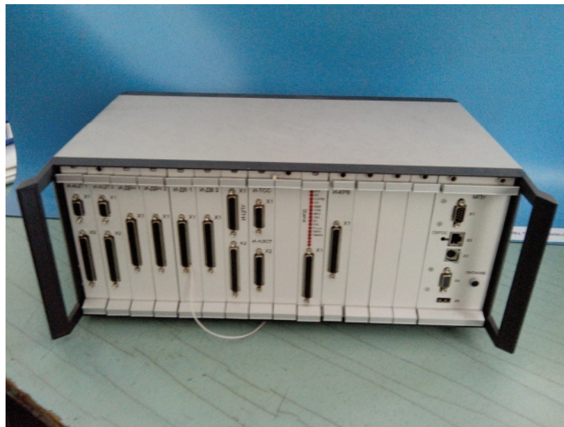
Рис. 1. Стенд-имитатор двигателя АИ-450М
