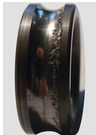
Рис. 4. Следы износа на внутренней обойме
