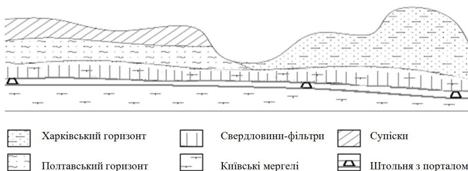
Рис. 2. Геологічний розріз дренажної штольні №47 "Видубицька".
