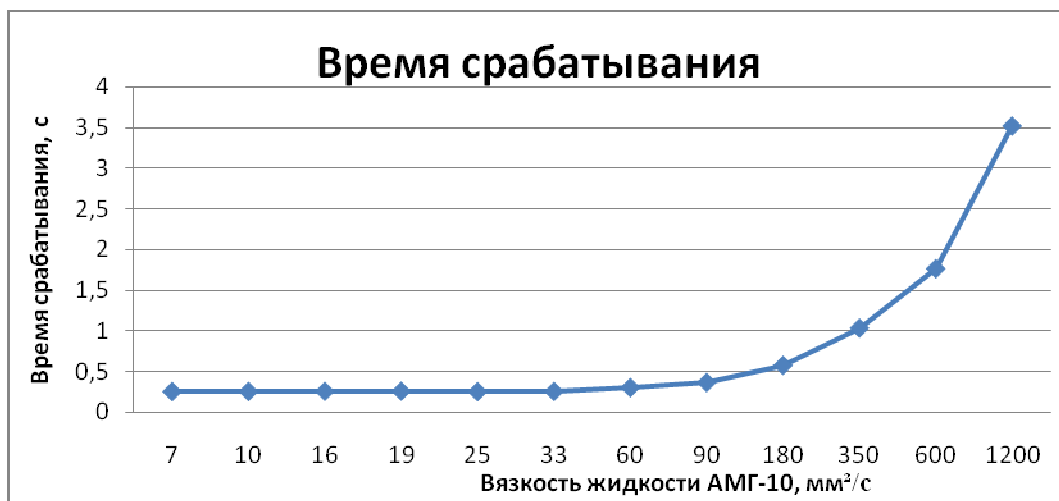
Рис. 5. Зависимость времени срабатывания исполнительного механизма от вязкости гидрожидкости
