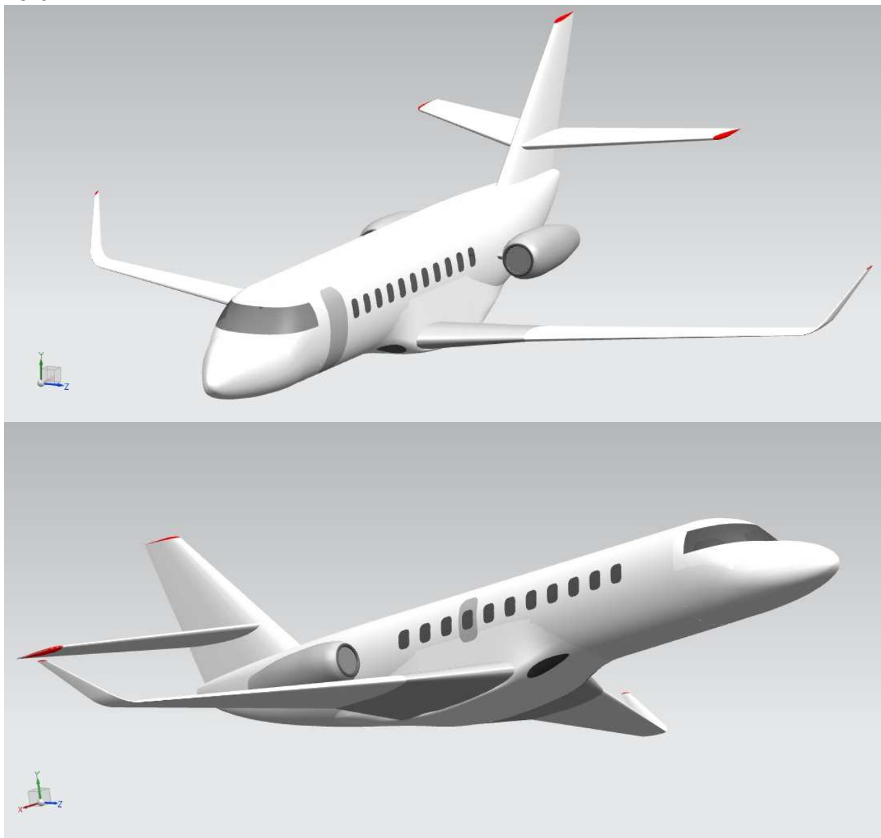
Рис. 2. Параметрическая модель мастер-геометрии самолета ХАИ-КС1
