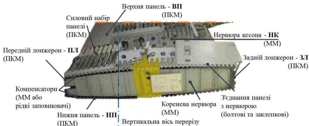
Рис. 2. Типова КК із ПКМ
