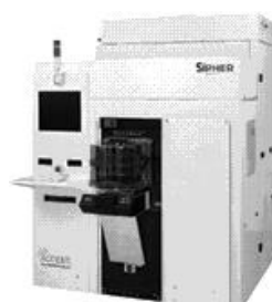
Рис. 3. Аналізатори кутових характеристик дифузного відбивання світла: a – TMS 2000; б – Keyence LT-8010.
