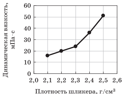
Рис. 4. Зависимость динамической вязкости шликера от его плотности при совместном введении диспергирующей добавки в количестве 0,3 % и упрочняющей добавки в количестве 0,2 %
