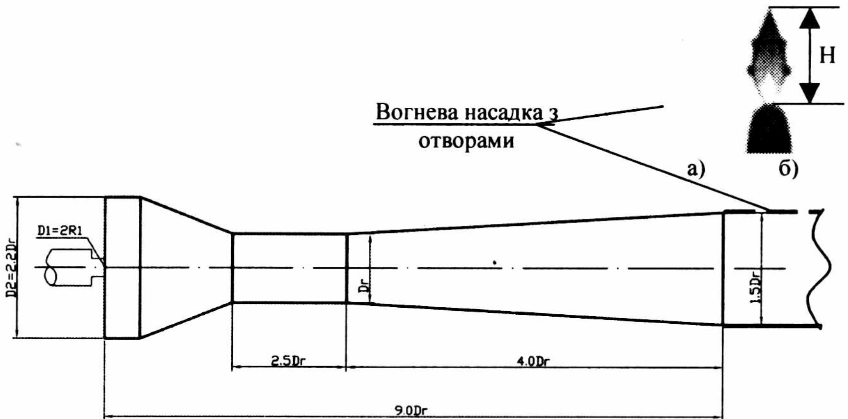
Рис. 1. Схема атмосферного пальника з \alpha' < 1 а) вогнева насадка без охолоджуючих стрижнів; б) вогнева насадка з охолоджуючими стрижнями.
