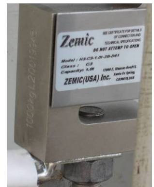
Рис. 1. Тензодатчик фірми Zemic типу H3
