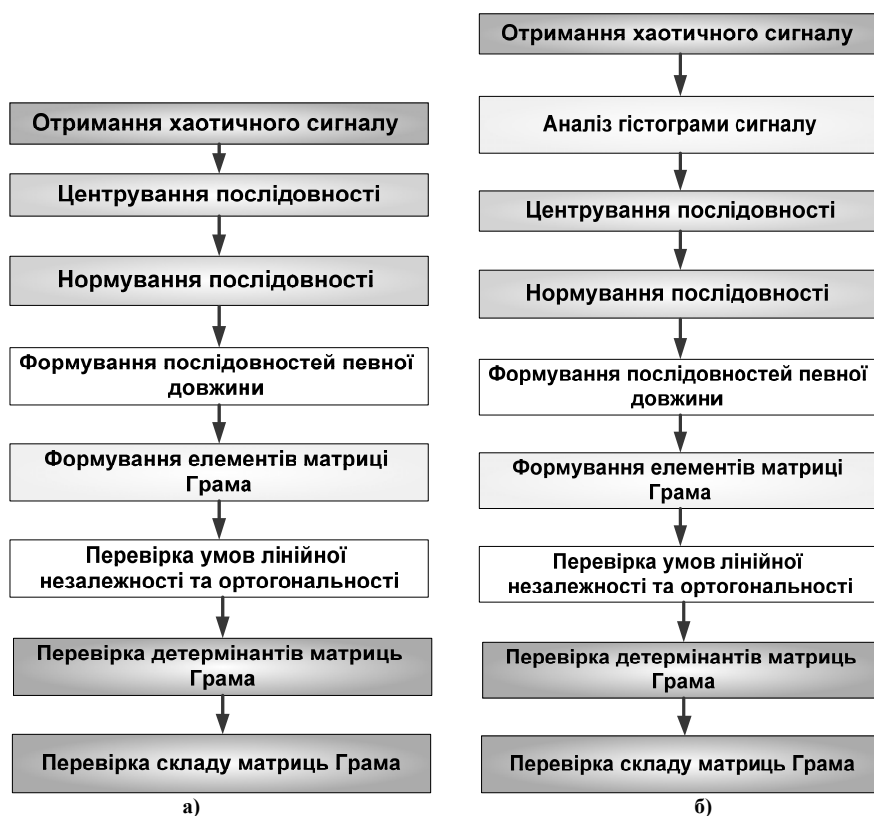
Рис. 2 Послідовність (а) та доповнена послідовність (б) методу визначення оптимального з точки зору апаратних витрат базису хаос-підносійних.
