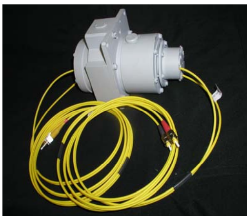
Рис. 7. Фотокартка оптичного обертового з'єднувача
