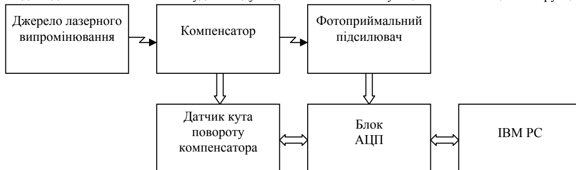
Рис. 12. Блок-схема установки для вимірювання величини оптичних втрат та амплітудно-кутової характеристики коефіцієнта передачі компенсатора.
