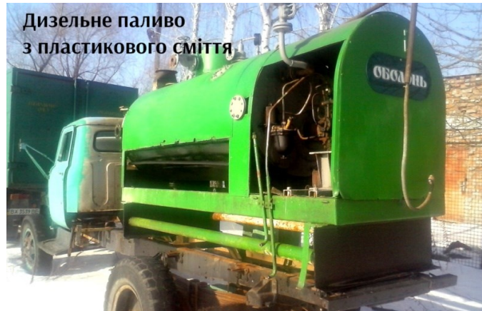
Рис. 1. Мобільна установка переробки пластикових пляшок у дизельне паливо компанії «Оболонь Ойл»
