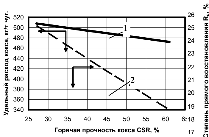
Рис. 2. – Влияние горячей прочности кокса CSR на удельный расход кокса (1) и степень прямого восстановления R d (2)
