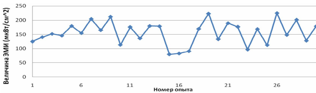
Рис. 2 – График замеров плотности потока энергии от СВЧ печь в момент ее работы с использованием нейтрализатора ЭМИ «Гамма-7»
