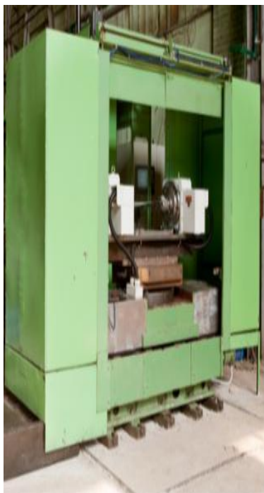
Рисунок 11 – Обработка турбинных лопаток на модернизированном обрабатывающем центре с ЧПУ модели ИС-800ПМФ4
