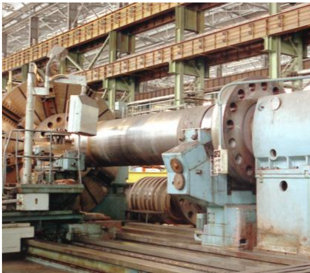
Рисунок 2 – Обработка вала гидротурбины на токарном станке фирмы Шкода
