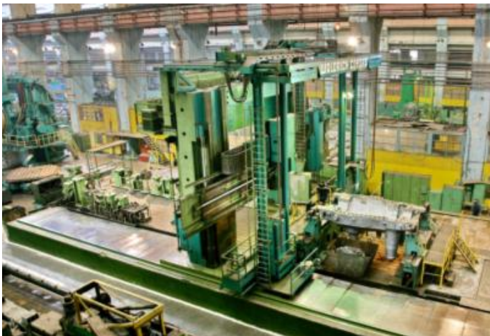
Рисунок 16 – Капитальный ремонт и модернизация специального продольно-обрабатывающего станка с ЧПУ модели NS-33Ф2
