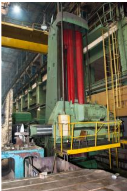
Рисунок 17 – Модернизация горизонтально-расточного станка модели W-200 фирмы Шкода
