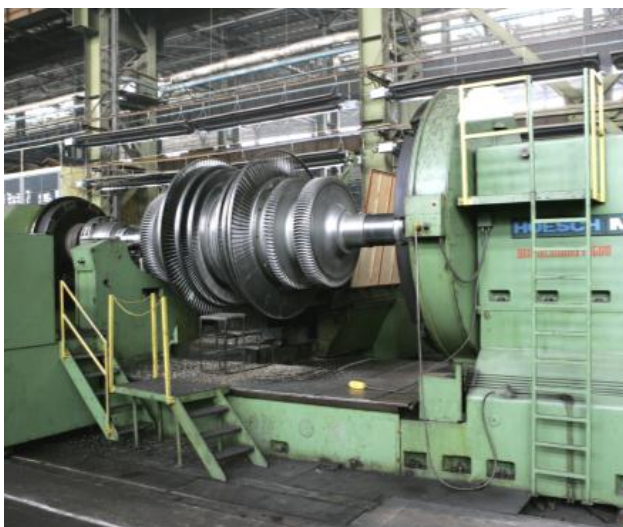
Рисунок 3 – Обработка ротора паровой турбины на токарном станке с ЧПУ фирмы Хёш
