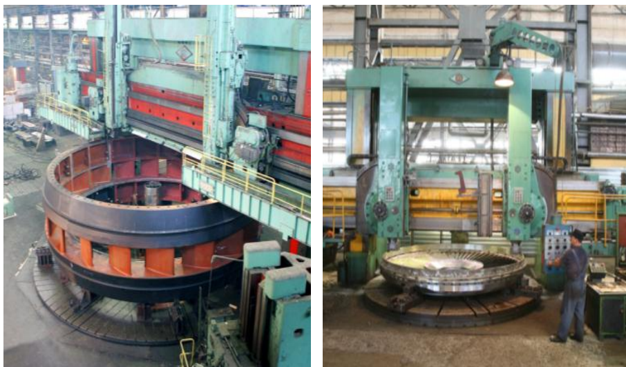
Рисунок 4 – Обработка статора ( a ) и диафрагмы ( б ) на токарно-карусельных станках моделей 1594 ( a ) и КУ-152Ф1 ( б )
