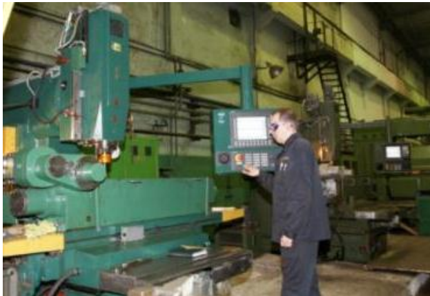
Рисунок 10 – Обработка рабочих лопаток паровых турбин на станке ЧПУ модели ГФ2253С1
