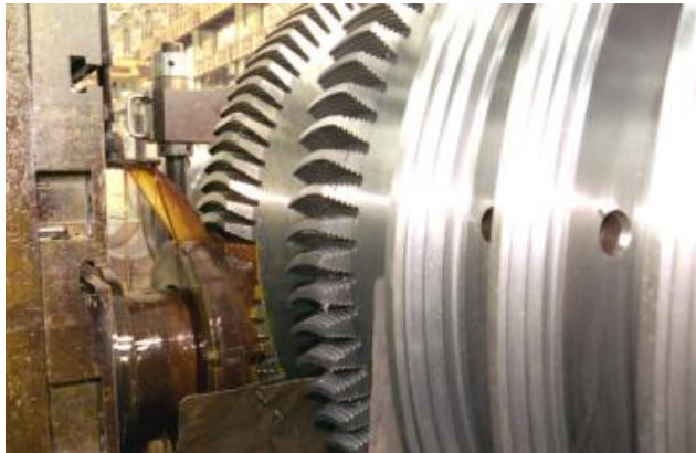
Рисунок 9 – Нарезание «елочных» пазов для установки лопаток последних ступеней паровой турбины мощностью 1 млн. кВт на роторно-фрезерном станке мод. КУ-324М
