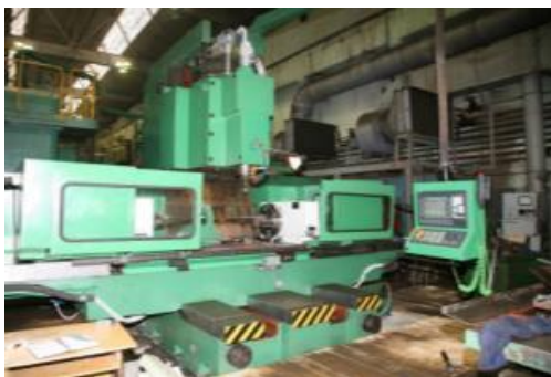
Рисунок 12 – Фрезерование турбинных лопаток по программе на станке модели 65A90Ф4
