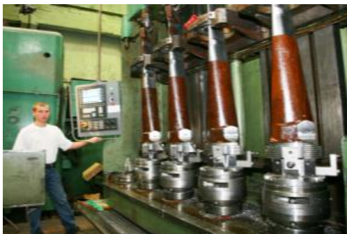
Рисунок 13 – Обработка турбинных лопаток на модернизированном станке с ЧПУ фирмы Форест
