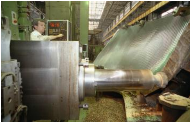
Рисунок 7 – Фрезерование лопасти гидротурбины на горизонтально-фрезерном станке фирмы Шисс
